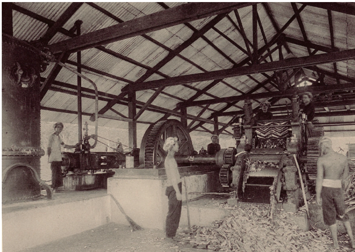
Planche 87 : moulin mécanique pour broyer la canne à sucre
